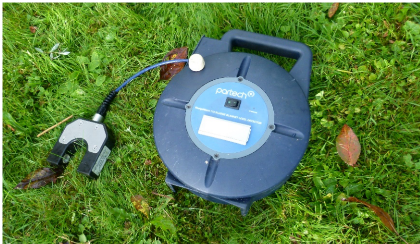
Bild 1 Slamlod fabrikerat Partech
