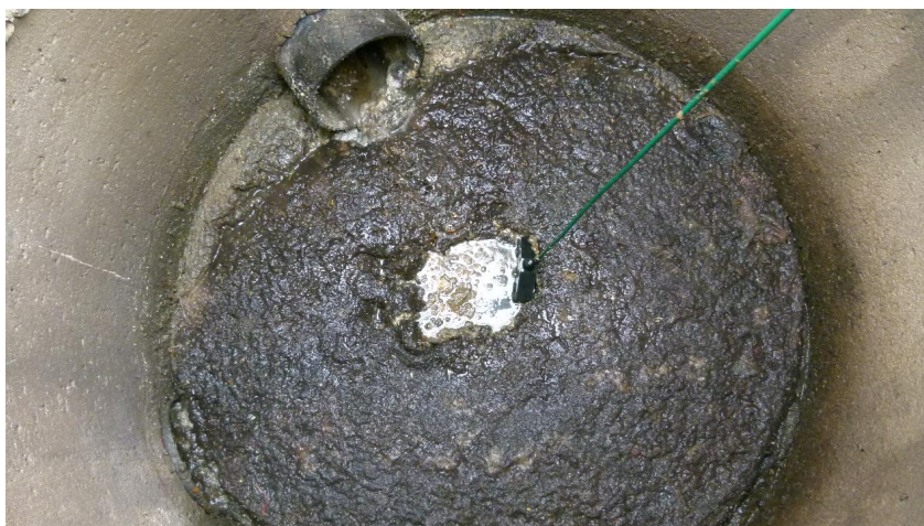
Bild 2 Slamlodets lina för att mäta vätskedjup
