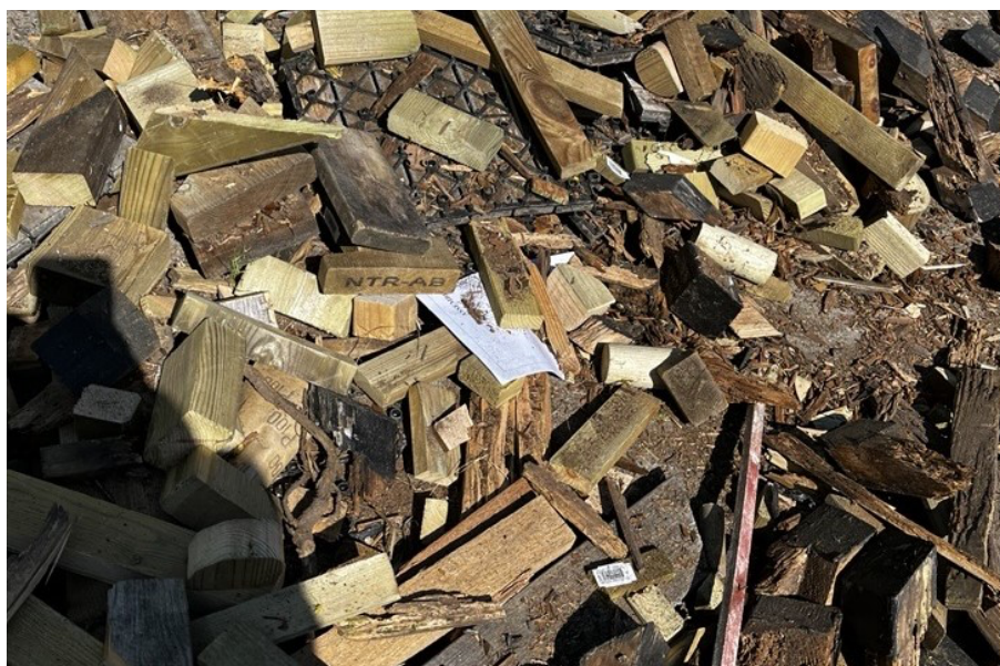
Figur 3. Exempel på fraktionen för impregnerat trä (Foto: Siri Ranung, Ramboll)
