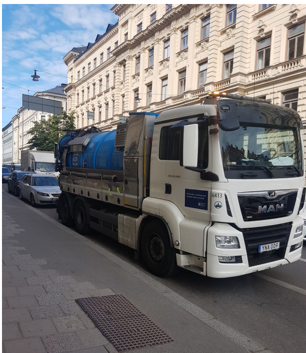
Slamtömningsbilar används vid hämtning av flytande matavfall. FOTO: DAINA MILLERS-DALSJÖ, URBAN EARTH
