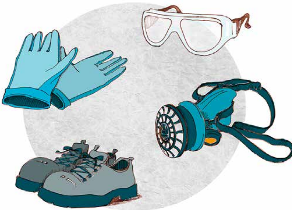
Figur 1. Exempel på skyddsutrustning för sortering av avfall vid plockanalys. Handskar som skyddar mot stick och skär; skor med stålhätta och spiktrampskydd; skyddsglasögon och andningsskydd med filter.
