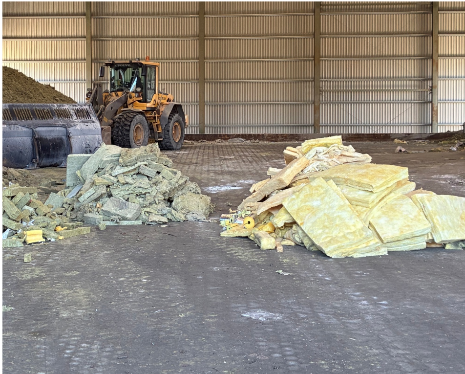
Figur 8: De insamlade mängderna stenull och glasull bredvid varandra på Stena Recyclings filial i Borås.
