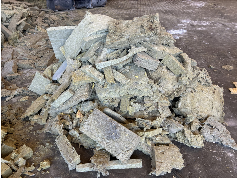
Figur 8: De insamlade mängderna stenull och glasull bredvid varandra på Stena Recyclings filial i Borås.
