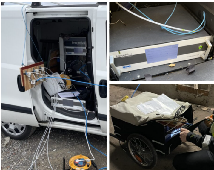
Bild 1. Mätinstrument Fresenius GA 320, ett monterat i bil och ett löst för montering på kärra.
