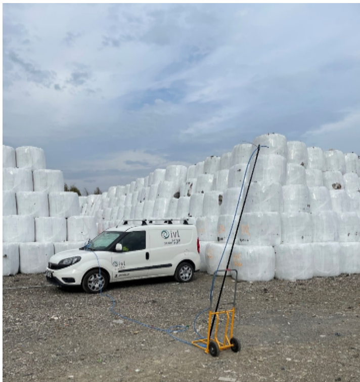
Bild 10. Utrustning för bakgrunds- och sniffringsmätning, intill balat avfallslager i Boden, 2024.
