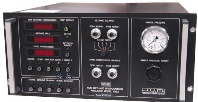
Figur 1. FID-instrument med inbyggd Cutter från tillverkaren JUM. Bildkälla: cleanair.com
