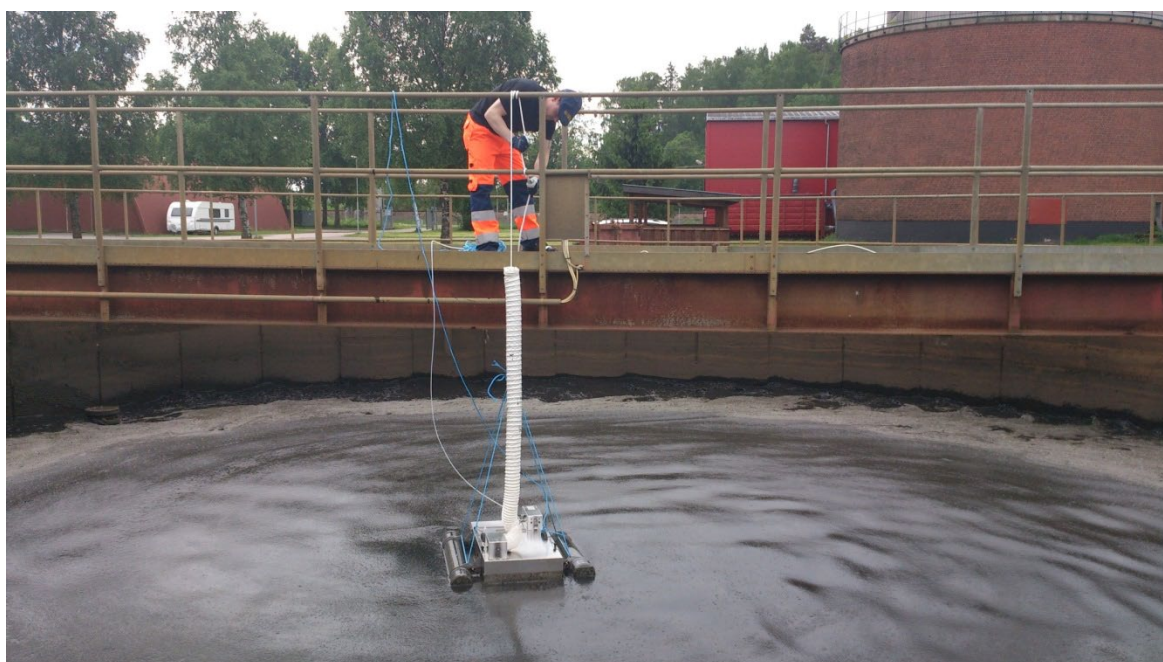
Figur 27. Huvmätning vid öppet rötrestlager.
