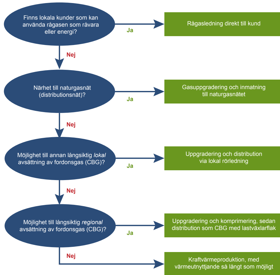
Figur 10. Beslutsstödsschema för biogasanläggning i storleksordningen 5–20 GWh/år.
